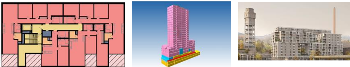
Abbildung 2: Beispielhafte Planungsgrundlagen (Grundrissvorschlag, 3D-Nutzungsmodell, Design-Visualisierung) für einen Design-Build-Wettbewerb
