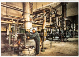
KOCHEREI Die Kocherei bildet das Herz der ganzen Fabrik. Hier wird mittels Säure die Knetmasse des Holzes (Lignin) in Lösung gebracht; dadurch werden die Zellulosefasern freigelegt.
